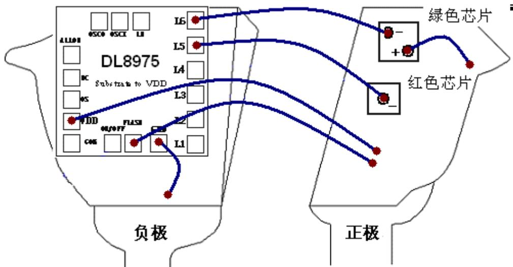
IC衬底请采用绝缘胶固定在LED负极支架上
